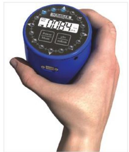
RADCOMPASS は、放射性物質が存在する位置を特定するためのコンパクトで使い易い低コストのソリューションを提供する装置です。この装置は、ガンマ線量率と 360° 方向の情報の両方が表示され、ファーストレスポnder、軍関係者、産業用としての放射線測定には理想的なツールです。
